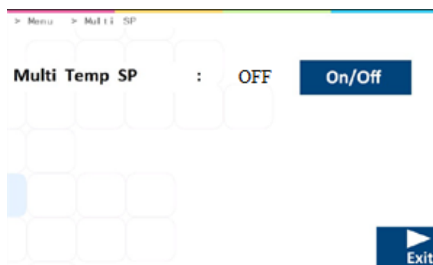
Slika 13.27 Prikaz više postavljenih vrijednosti temperature na višeprostorim IVF inkubatorima MIRI® TL6 i MIRI® TL12
