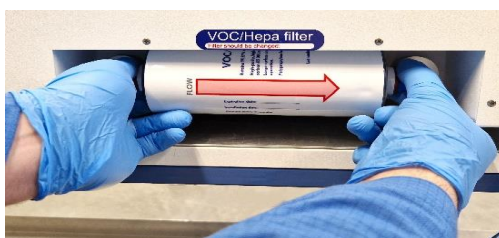
Slika 12.2 Postupak umetanja i uklanjanja VOC/HEPA filtra
